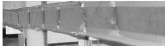
Figure 4: Mise en évidence expérimentale de roll waves.
