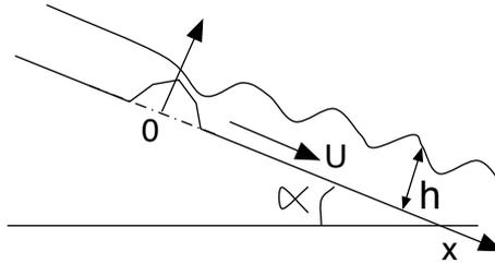
Figure 1: *Écoulement à surface libre sur un plan incliné*
